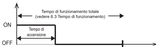
Fig. 18: Modalità di funzionamento Timer I/O
